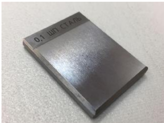
Рисунок 2 - Общий вид отдельных образцов шероховатости поверхности (сравнения) модификации В7-1833
