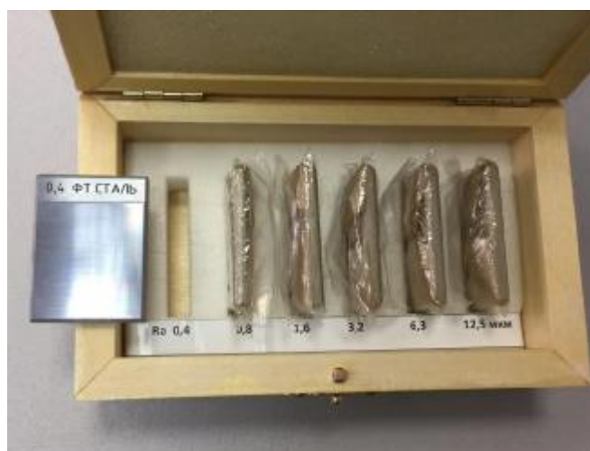
Рисунок 1 - Общий вид наборов образцов шероховатости поверхности (сравнения) модификации В7-1833
