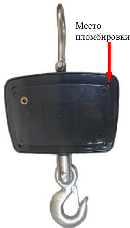
Рисунок 1 - Схема пломбирования от несанкционированного доступа, обозначение места нанесения знака поверки
