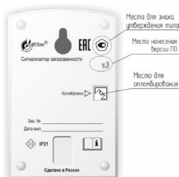
Рисунок 3 – Схема пломбировки от несанкционированного доступа и место нанесения знака утверждения типа
