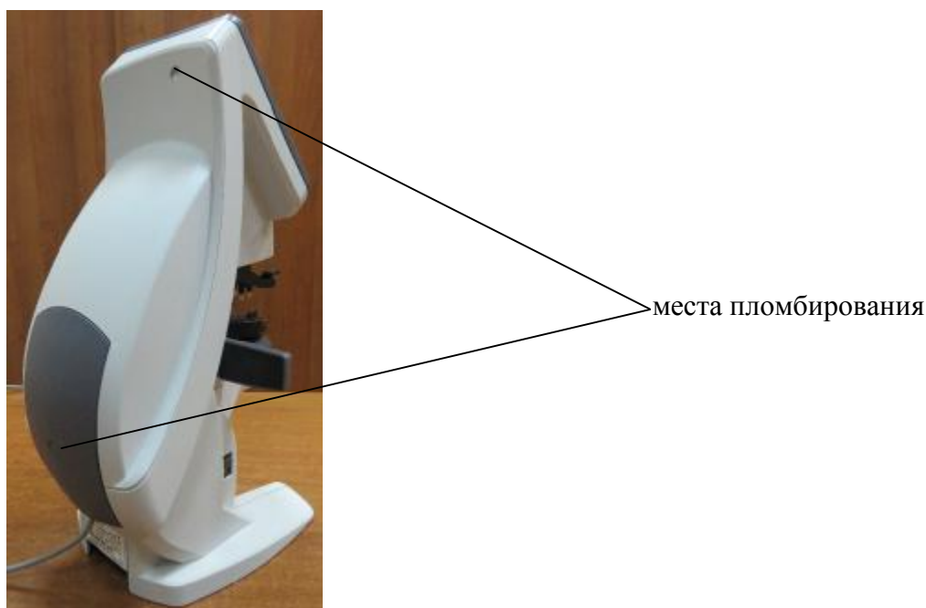
Рисунок 2 – Схема пломбирования линзметров ЛЭМ -1 от несанкционированного доступа
