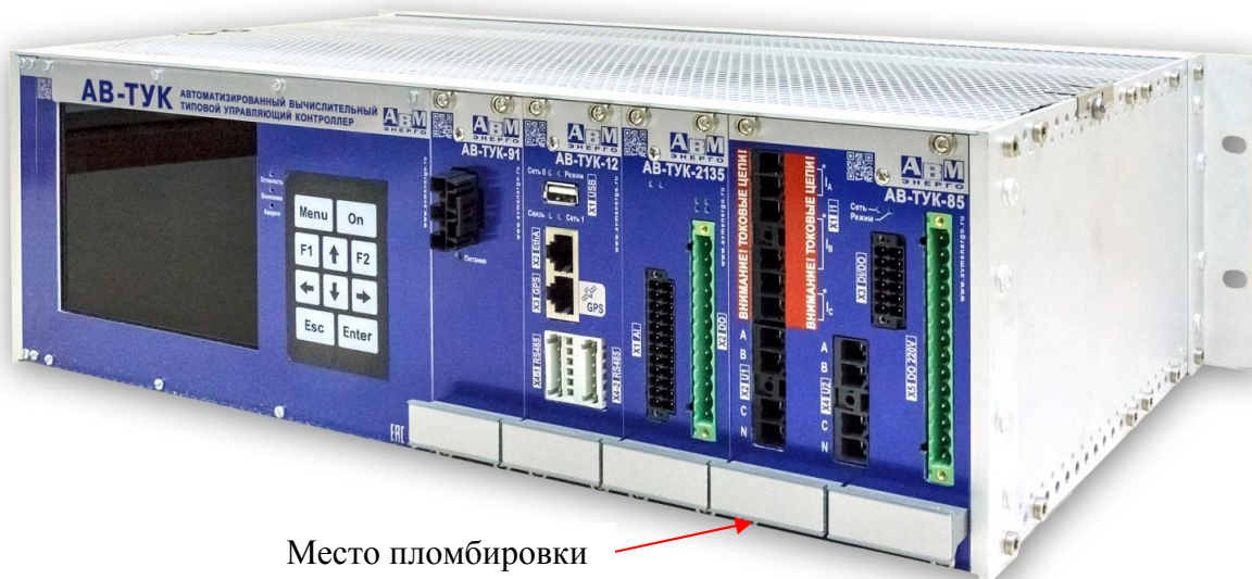
Рисунок 1 - Общий вид контроллера (однокрейтовое исполнение) и обозначение места пломбировки от несанкционированного доступа
