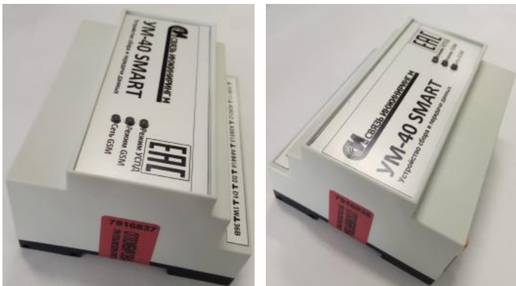
Рисунок 2 – Места нанесения пломбировочных наклеек на боковые поверхности устройства
