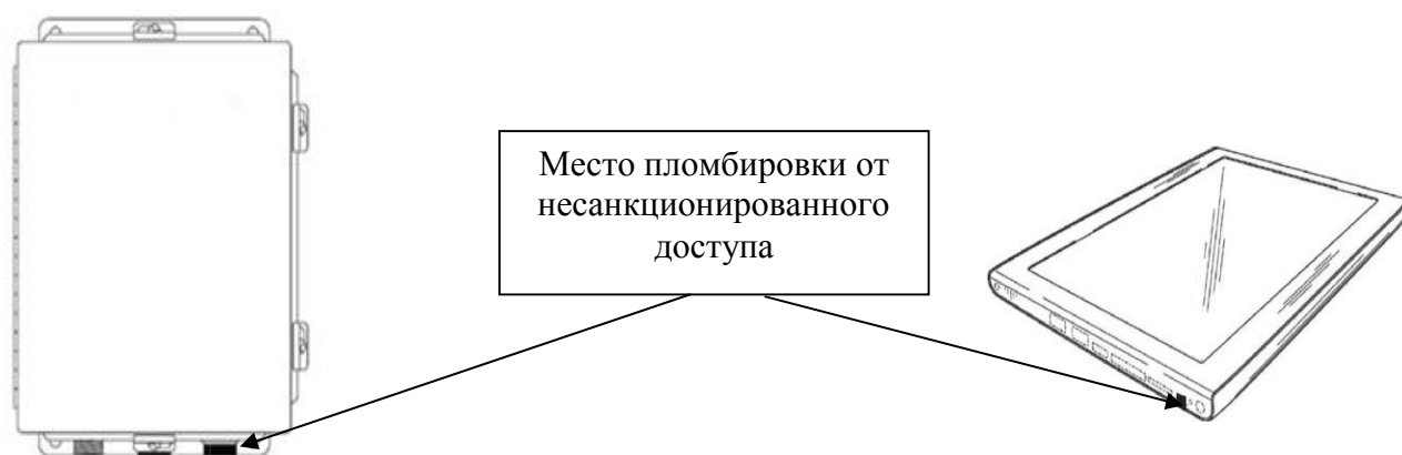
Рисунок 3 – Место пломбировки Системы от несанкционированного доступа
