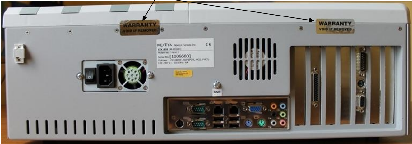
Рисунок 2 – Схема пломбировки от несанкционированного доступа
