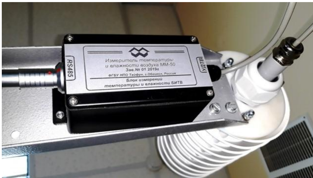
Блок измерения температуры и влажности воздуха БИТВ с узлом датчиков температуры и влажности УДТВ в радиационной защите
