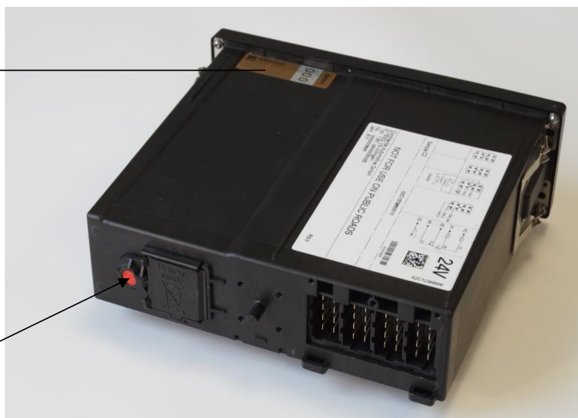
Рисунок 2 – Место нанесения защитной наклейки.
