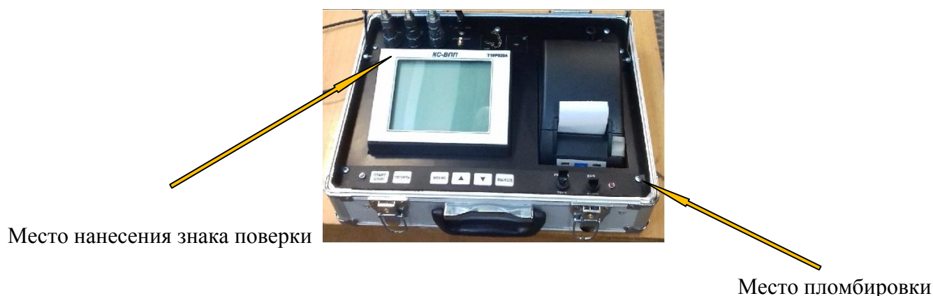
Рисунок 2 – Схема пломбировки от несанкционированного доступа и обозначение места нанесения знака поверки.
