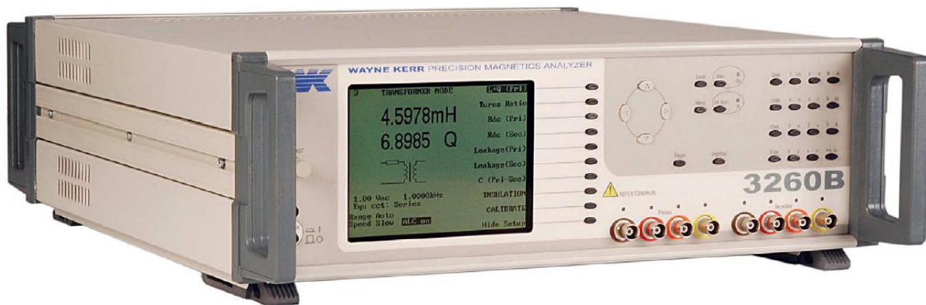
Рисунок 1 – Общий вид анализатора индуктивности прецизионного WK 3260B
