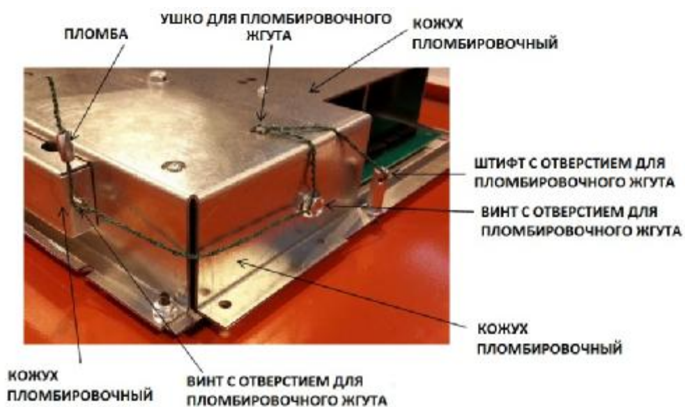
Рисунок 7 – Пломбировка механического сумматора учета
