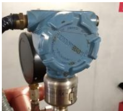
Рисунок 2 – Схема пломбировки преобразователя давления измерительного 3051S
