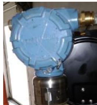
Рисунок 2 – Схема пломбировки преобразователя давления измерительного 3051S
