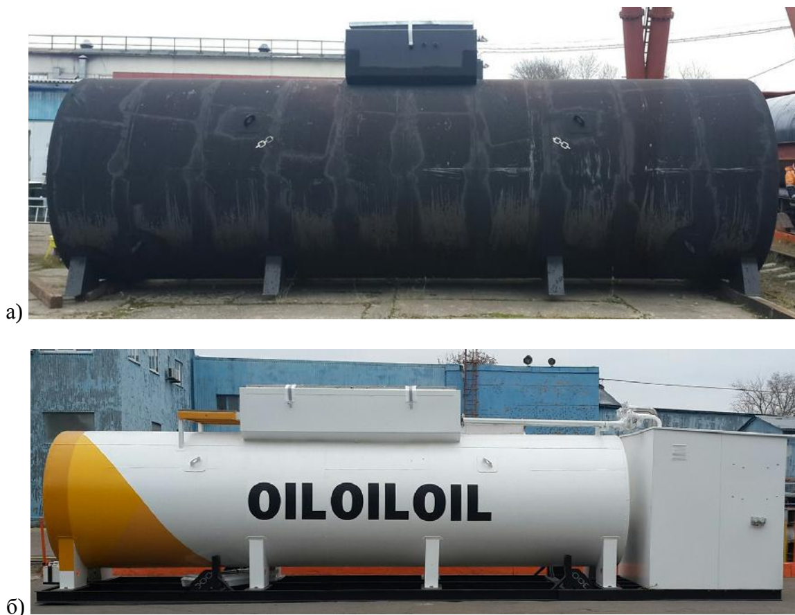
Рисунок 1 – Общий вид резервуаров горизонтальных цилиндрических РТ
