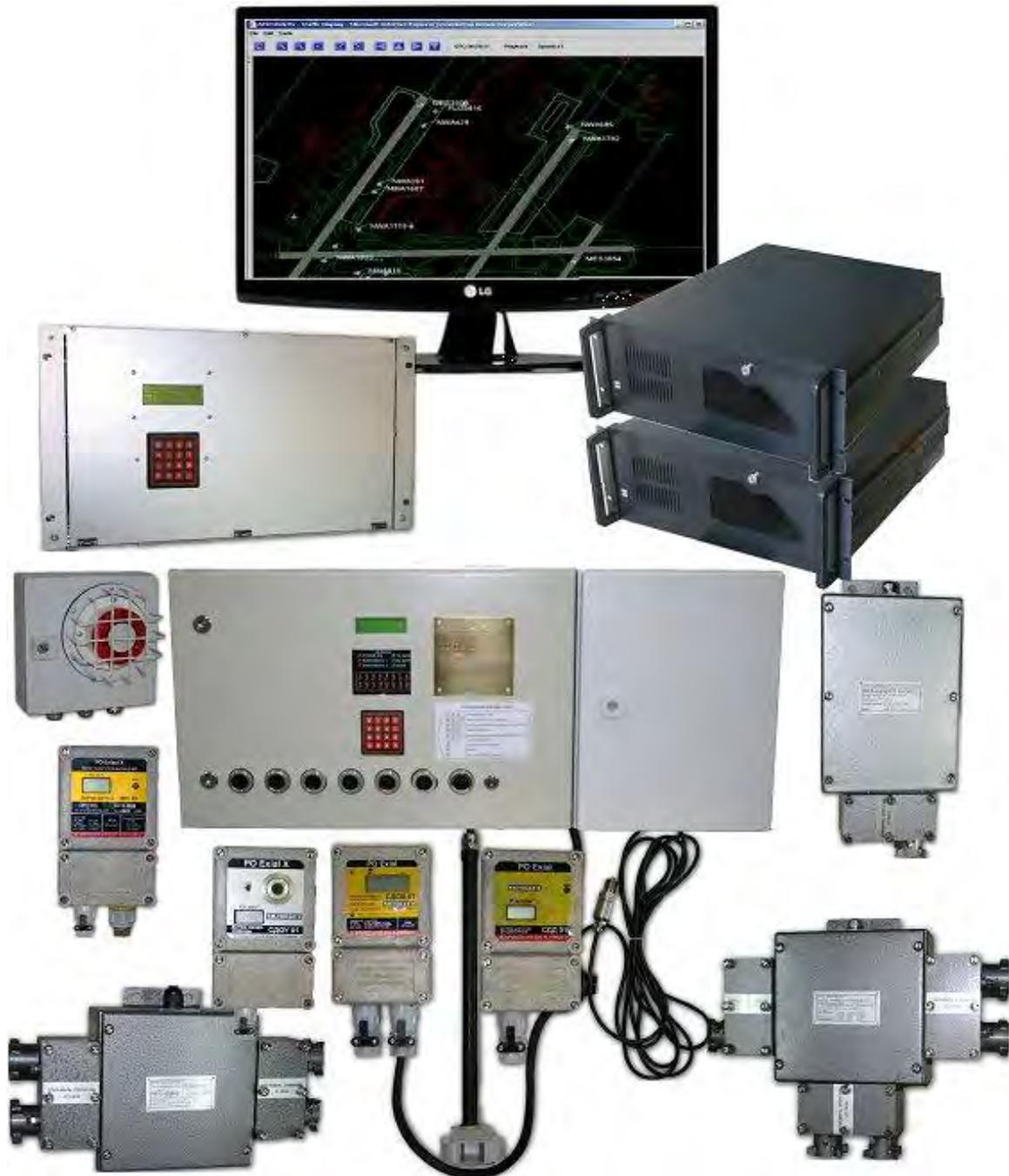
Рисунок 1 – Общий вид основных технических средств системы «Микон 1Р»
