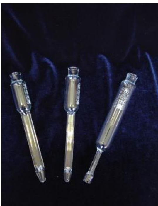
Бутирометры представляют собой стеклянный прибор, состоящий из корпуса, в верхней части которого припаяна трубка со шкалой, заканчивающаяся головкой, запаянной сверху.
