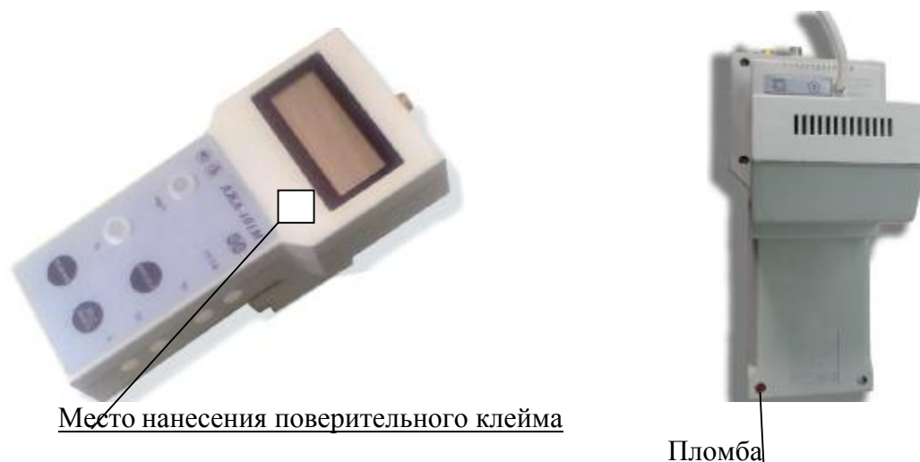
Рисунок 2 – Схема нанесения знака поверки (слева) и опломбирования (справа)
