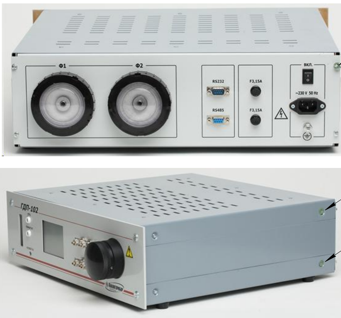
Рисунок 2 - Схема пломбировки генераторов от несанкционированного доступа, обозначение мест для нанесения оттисков клейм (показаны стрелками)
