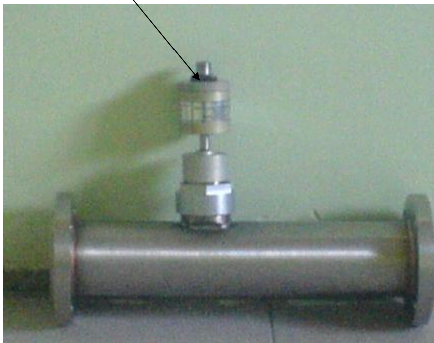
Рисунок 2 - Схема пломбировки от несанкционированного доступа
