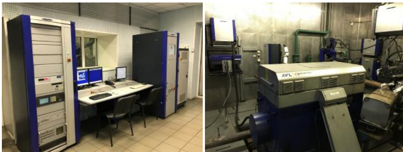
Рисунок 1 - Общий вид стенда для испытаний двигателей внутреннего сгорания с системой автоматизации PUMA Open HD EMISSIONS
