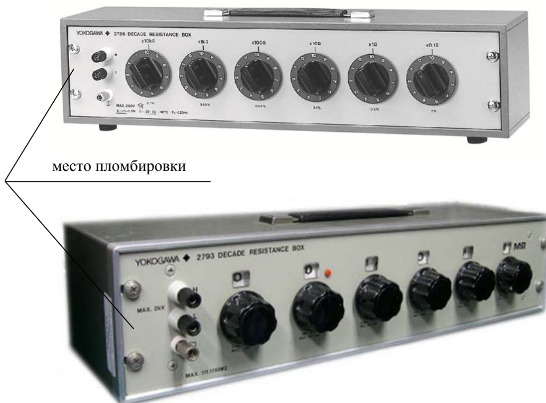
Рисунок 1 - Общий вид магазинов электрического сопротивления серии 2700 и место пломбировки
