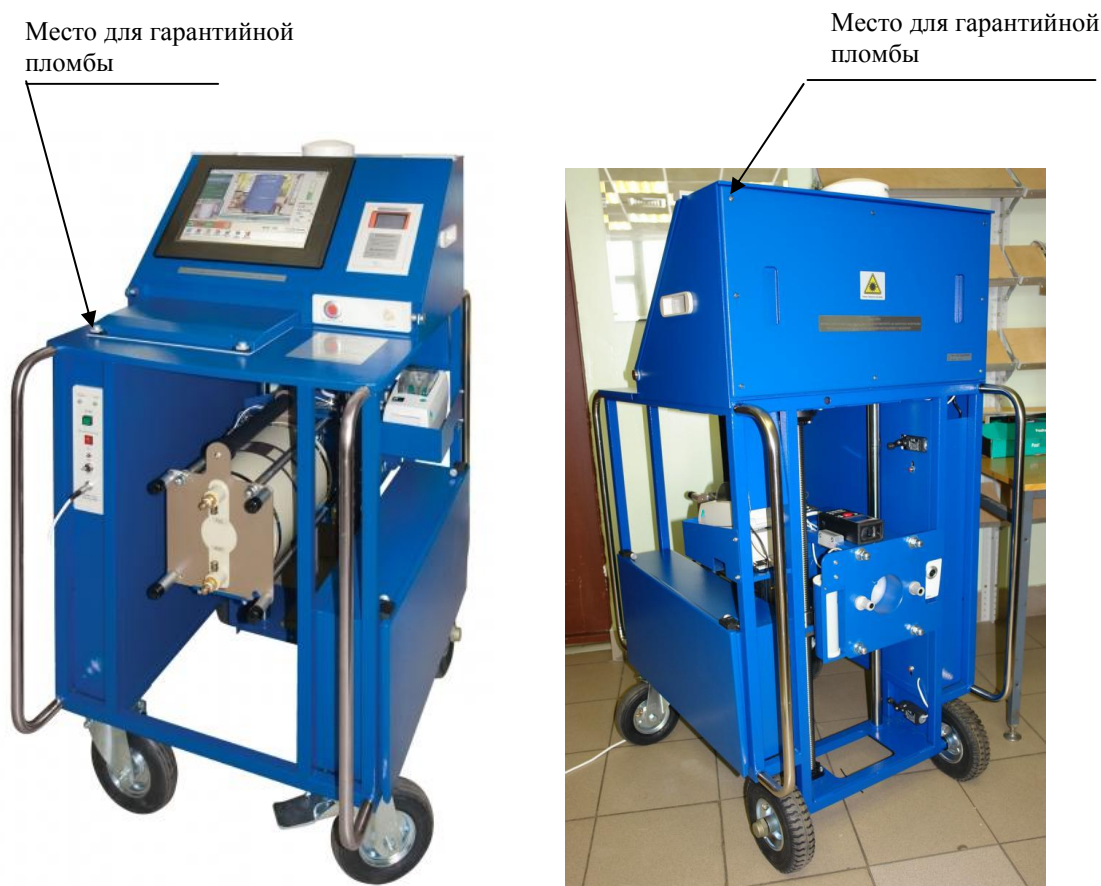
Рисунок 1 - Общий вид установки и схема пломбировки от несанкционированного доступа
