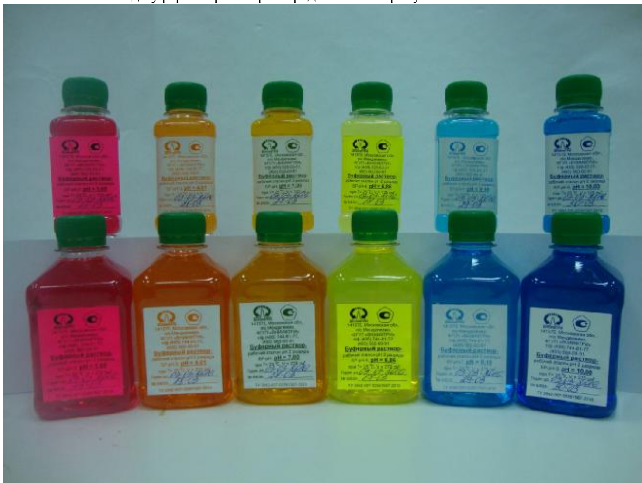
Рисунок 1 Буферные растворы-рабочие эталоны pH 2-го разряда БР-pH
