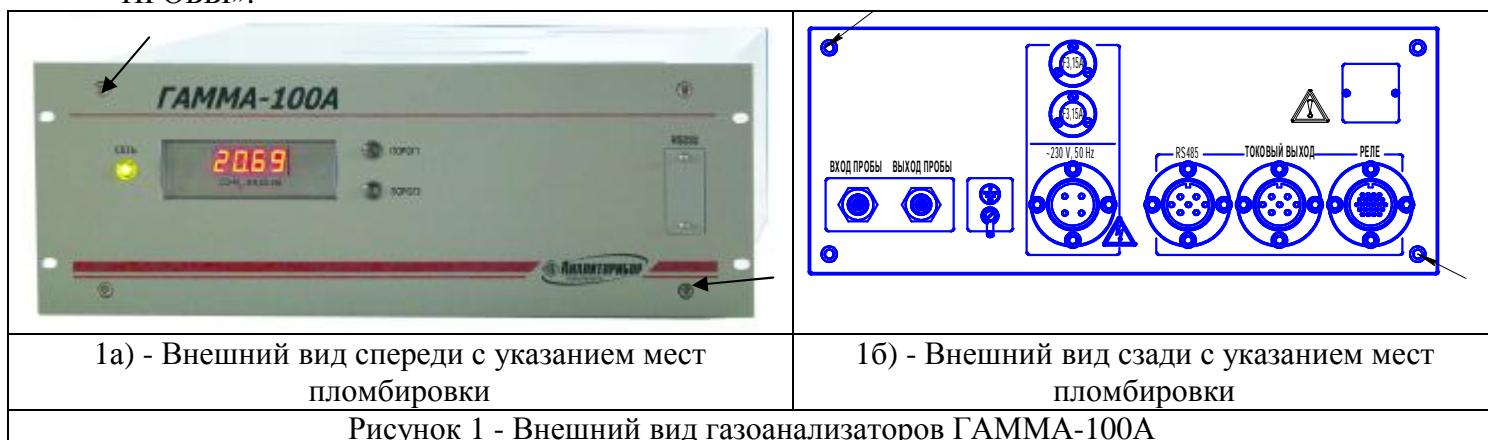
1a) - Внешний вид спереди с указанием мест пломбировки
