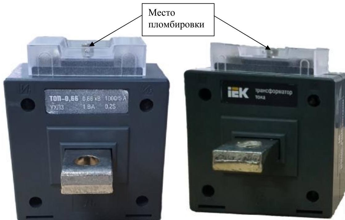
Рисунок 1 – Общий вид средства измерений и схема пломбировки от несанкционированного доступа
