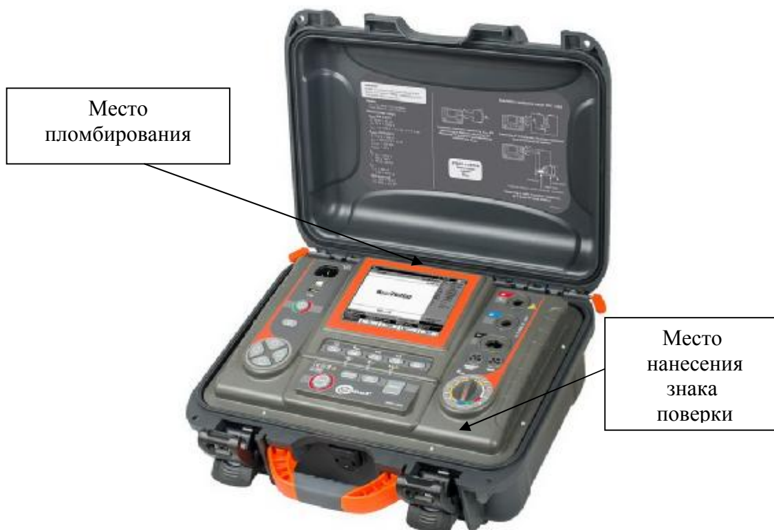
Рисунок 4 – Общий вид измерителей модификации МІС-10k1, место нанесения знака поверки и места пломбирования
