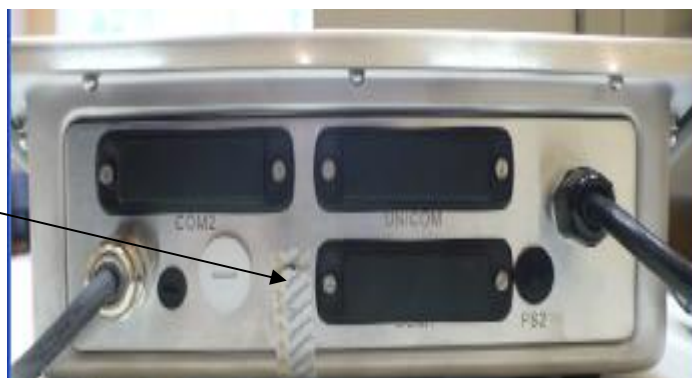
Рисунок 2 – Схема пломбировки от несанкционированного доступа терминала (вид сзади)
