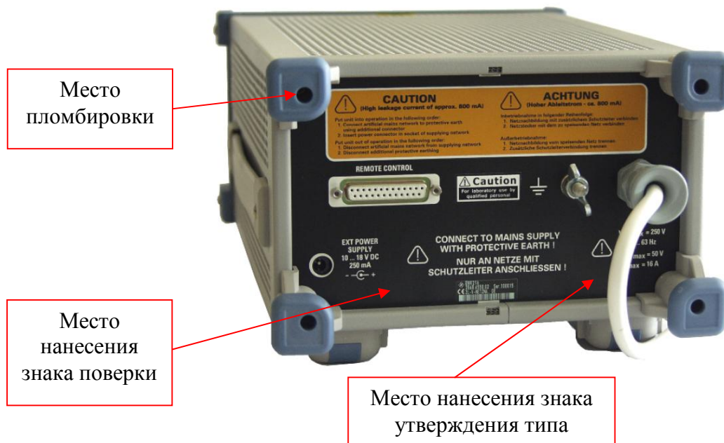
Рисунок 2 - Схема пломбировки от несанкционированного доступа, места нанесения знака поверки и знака утверждения типа
