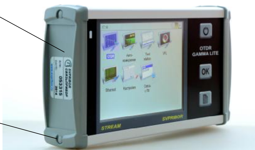
Рисунок 2 – Место пломбирования от несанкционированного доступа
