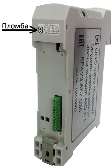
Рисунок 4 – Фотография контроллера в компактном исполнении с указанием места нанесения пломб
