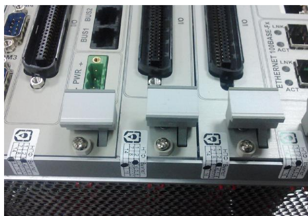
Рисунок 3 – Фотография контроллера в крейтовом исполнении с указанием места нанесения пломб
