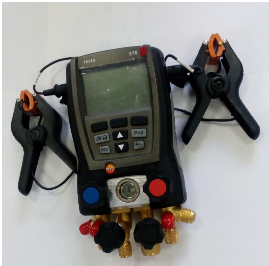
Рисунок 1 - Внешний вид измерителей давления цифровых Testo 570
