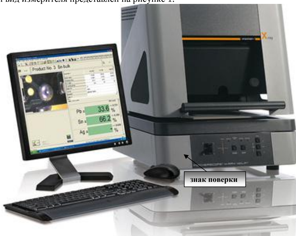
Рисунок 1 – Фото общего вида измерителя с указанием места нанесения знака поверки в виде наклейки
