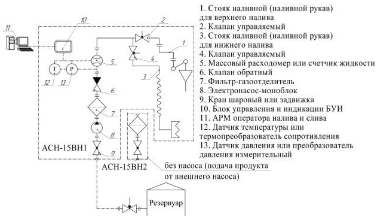
Рисунок 4 – Система измерительная комбинированного налива: АСН-15ВН1 (с насосом), АСН-15ВН2 (без насоса). Измерительная схема
