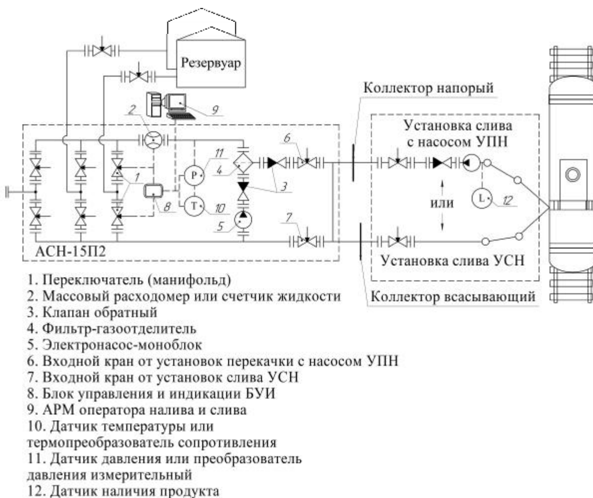
Рисунок 8 – Система измерительная для приёмки и перекачки продукта от ЖД цистерн в резервуары (групповой/поколлекторный учет) и между резервуарами АСН-15П2. Измерительная схема
