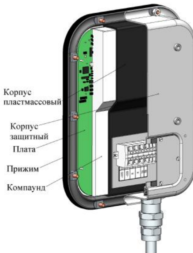
Рисунок 10 – Схема пломбировки БУИ от несанкционированного доступа
