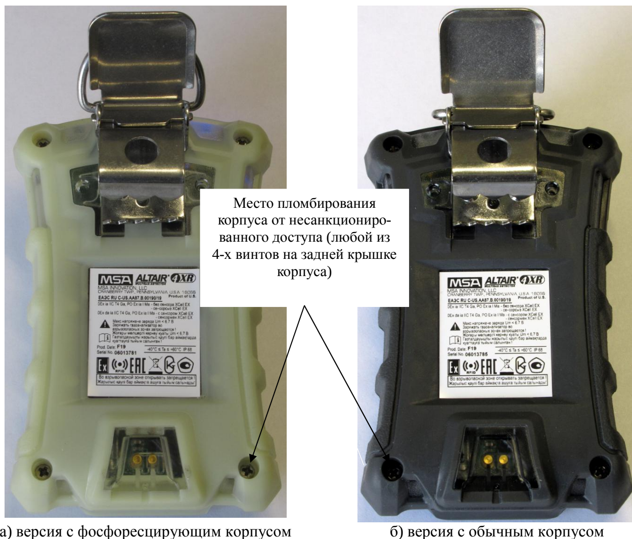
Рисунок 2 - Схема пломбировки корпуса газоанализаторов от несанкционированного доступа
