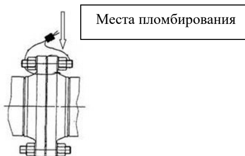
Рисунок 2 – Схема пломбировки от несанкционированного доступа, обозначение места нанесения знаков поверки на фланцевые соединения преобразователей расхода жидкости ультразвуковых DFX-MM, входящих в состав установки
