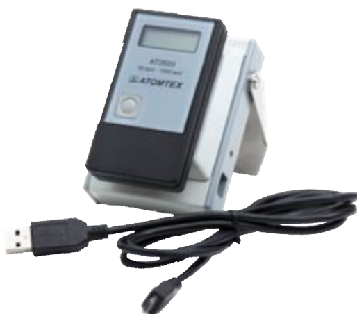
Рисунок 3 – Общий вид дозиметров совместно с устройством считывания
