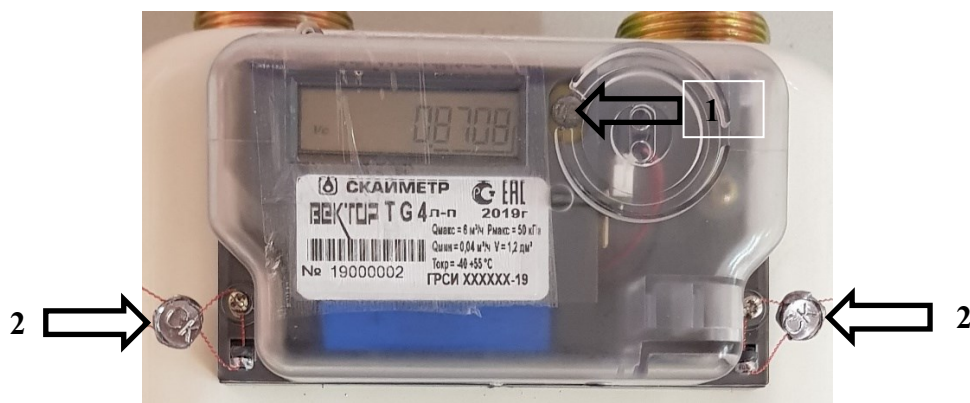
Рисунок 2 – Схема пломбировки от несанкционированного доступа, обозначения места нанесения знака поверки счетчиков газа диафрагменных ВЕКТОР исполнения «ВЕКТОР Т» и «Вектор ТК» (1 – место для установки знака поверки, 2 – место для установки пломбы изготовителя или поставщика газа)
