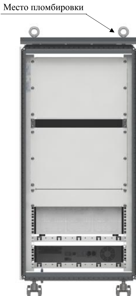
Рисунок 2 – Схема пломбировки от несанкционированного доступа системы автоматизированной измерительной ЦБВ
