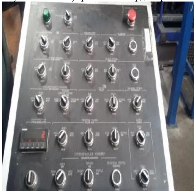
Рисунок 2 - Блок управления твердомера Р-400
