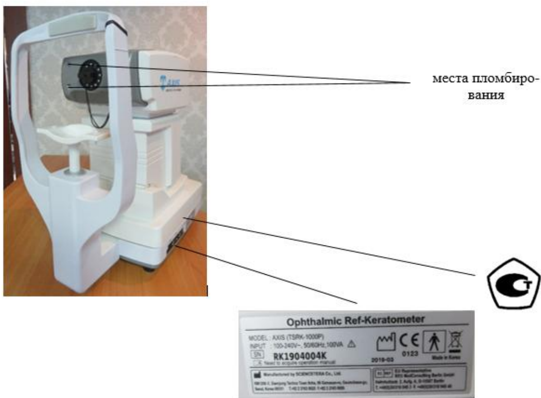
Рисунок 2 – Общий вид, схема маркировки и схема пломбирования от несанкционированного доступа авторефрактометра AXIS (TSRK-1000P)
