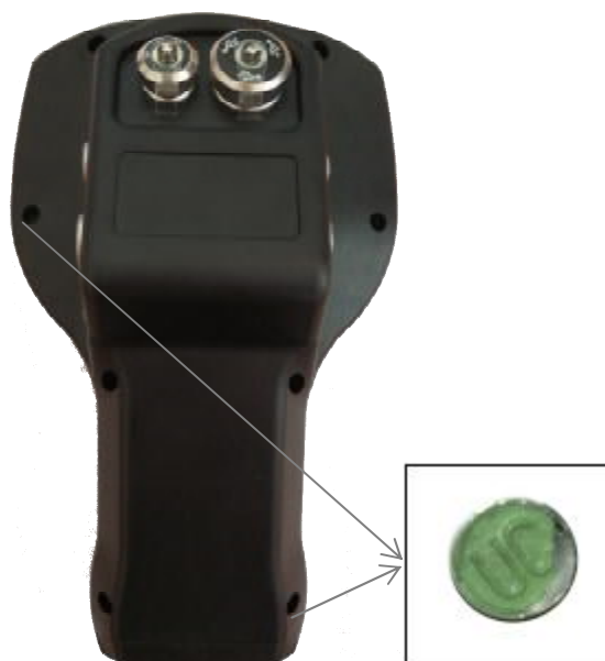
Рисунок 2 – Схема пломбировки от несанкционированного доступа
