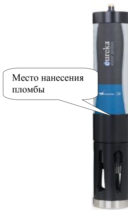
Рисунок 8 – Схема пломбировки от несанкционированного доступа
