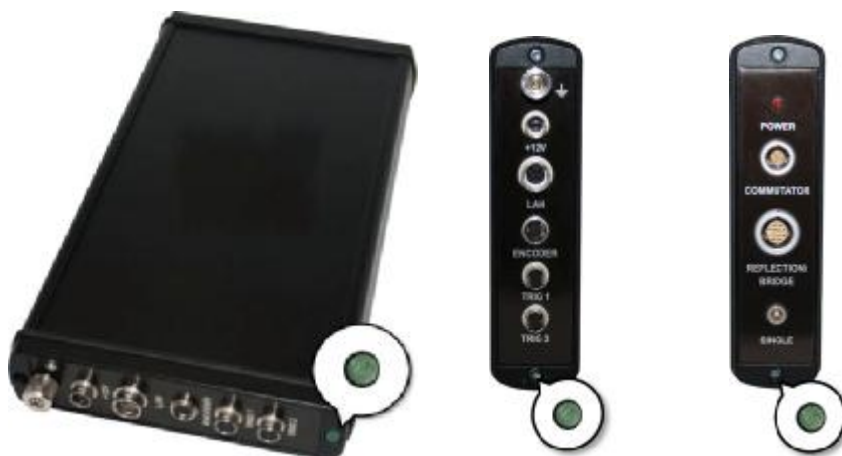
Рисунок 5 – Места пломбировки блоков канальных вихретоковых модулей установки
