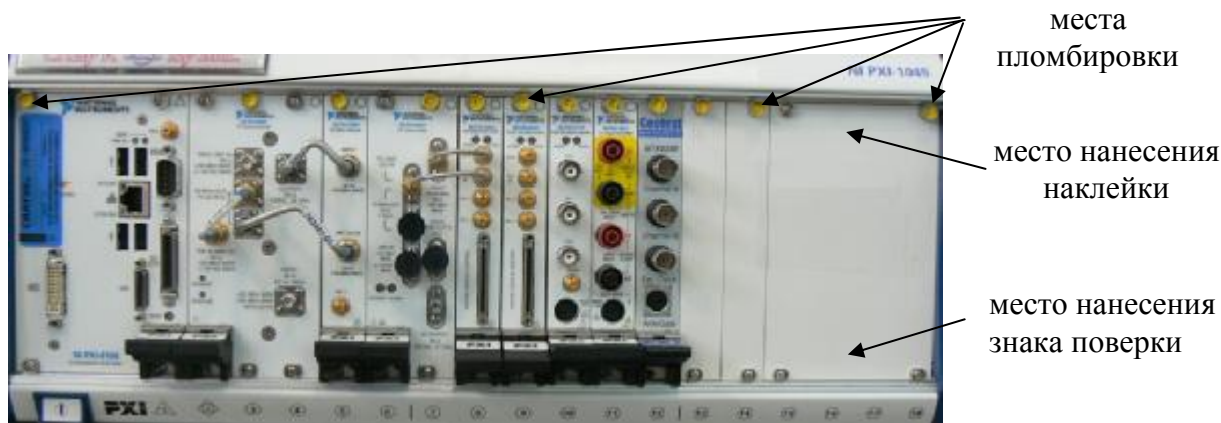
Рисунок 2 - Схема пломбировки, нанесения наклейки и знака поверки
