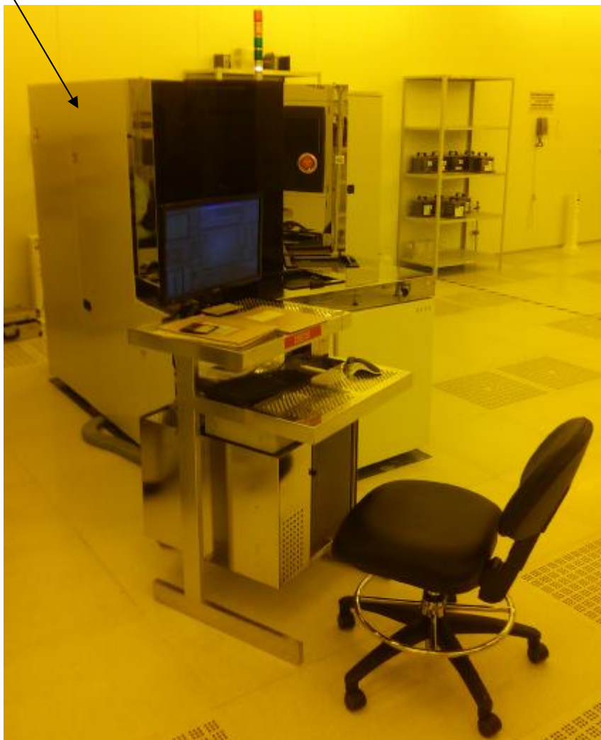
Рисунок 1 - Общий вид установки контроля линейных размеров КЛ-1
