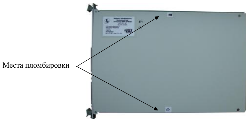
Рисунок 2 – Схема пломбировки от несанкционированного доступа функциональных модулей систем
