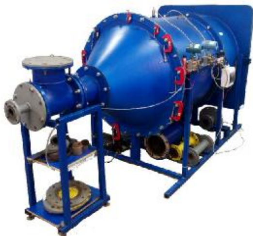
Рисунок 1 – Общий вид установки поверочной УПСГ-2500
