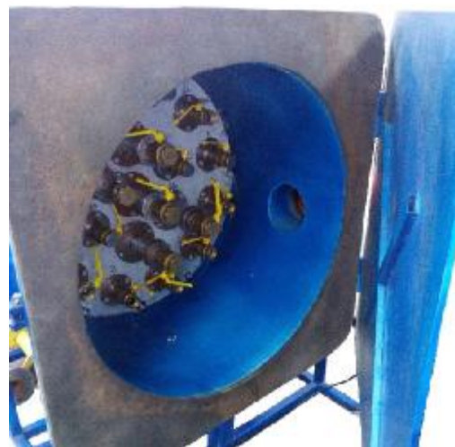
Рисунок 2 – Общий вид соплового блока с набором критических сопел
