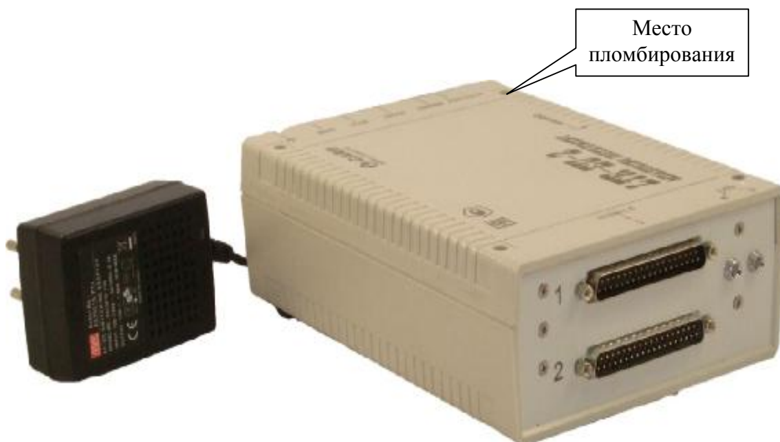
Рисунок 3 – Общий вид установок LTR-EU-2 и место пломбирования от несанкционированного доступа
