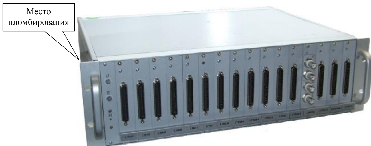
Рисунок 6 – Общий вид установок LTR-EU-16 и место пломбирования от несанкционированного доступа
