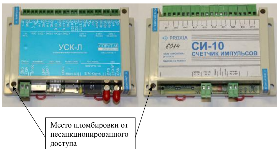
Рисунок 2 – Схема пломбировки от несанкционированного доступа
